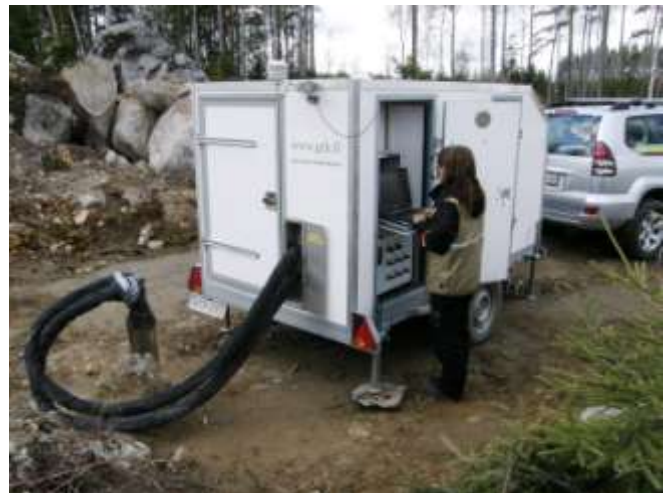
TRT-mittausvaunu kytkettynä energiakaivoon.
