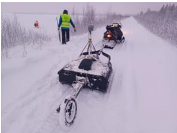
Kuva 6. Perinteinen maatutka moottorikelkan perässä olevassa ahkiassa, johon on liitetty myös RTK-GPS-vastaanotin.
