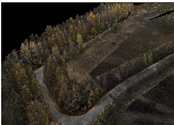
Kuva 18. Laserkeilauksesta tuotettu pistepilvimalli.
