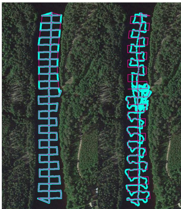
Kuva 24. Vasemmalla GPR-droonin – ja oikealla luotauslautan toteutuneet mittauslinjat mittauspaikassa 1.
