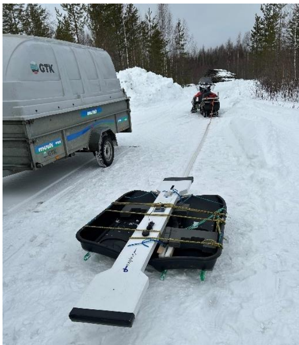
Kuva 4. GEM2H-mittalaite liitettyä moottorikelkkaan. Lähetin ja vastaanotin ovat kiinteästi 2.5 metrin päässä toisistaan laitteen vastakkaisissa päissä.
