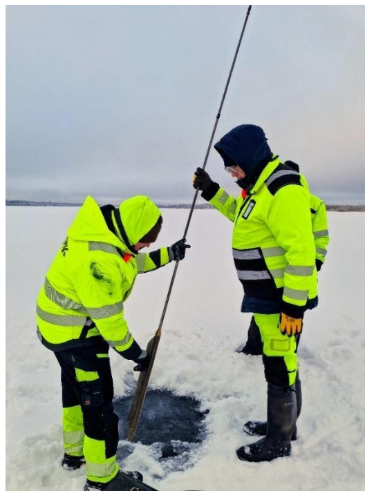
Kuva 8. Laippakairan eli ns. venäläisen kairan käyttöä Otanmäen lintukosteikolla tammikuussa 2026.
