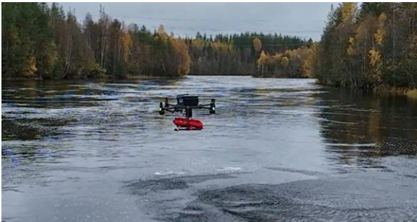
Kuva 3. GPR-Drooni Emäjoella syksyllä 2025.
