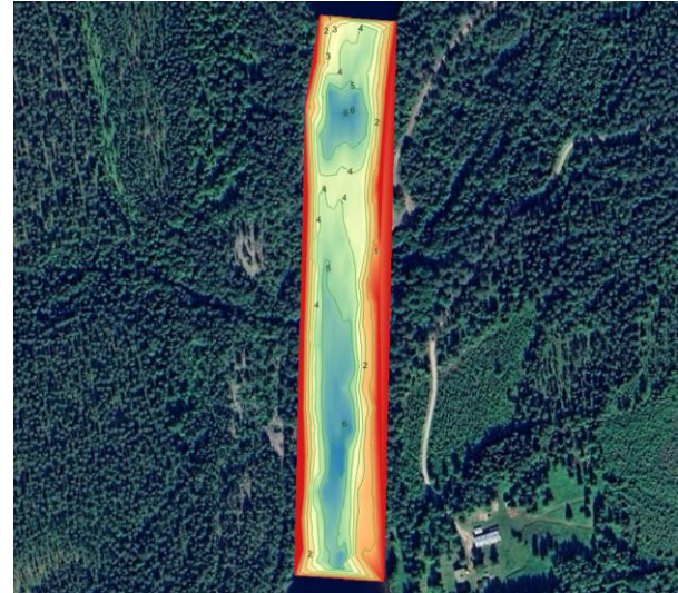
Kuva 14. Mittauspaikan 1 syvyyskartta tehtiin GPR droonin tuottamasta mittausdatasta QGIS-ohjelman avulla.
