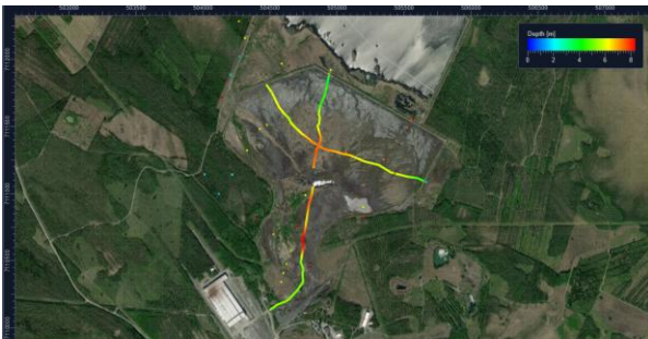
Kuva 14. 100 MHz:n mittausten tulokset (kuvat 11, 12 ja 13) yhdistettynä.
