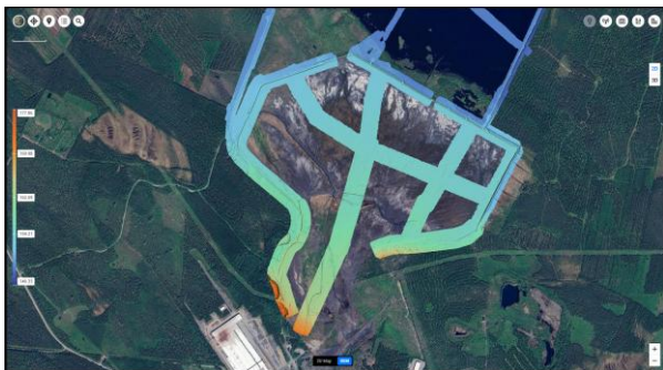
Kuva 27. Laserkeilauksen tuloksena tuotettu DEM-kartta rikastushiekka-altaasta ja sen padoista.
