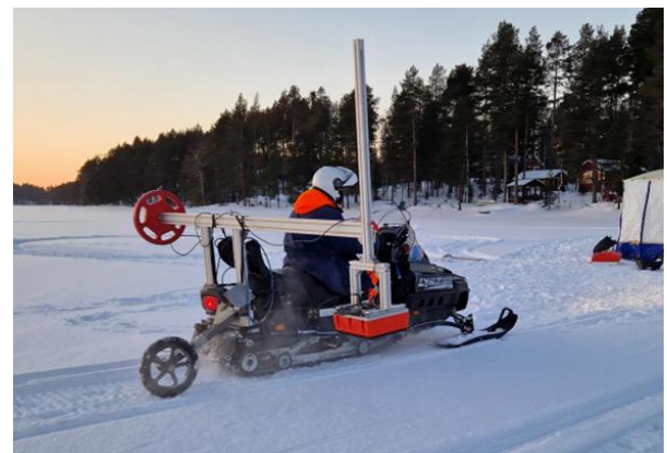
Kuva 5. Maatutka moottorikelkkaan asennettuna.
