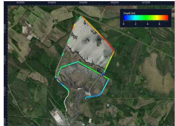
Kuva 17. 200 MHz:n maotkusten tulokset patorakenteiden syvyyttulkintoina.
