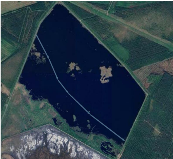
Kuva 10. GPR-Droonin suunniteltu reitti ja toteutettu 100MHz antennilla keväällä 2025.
