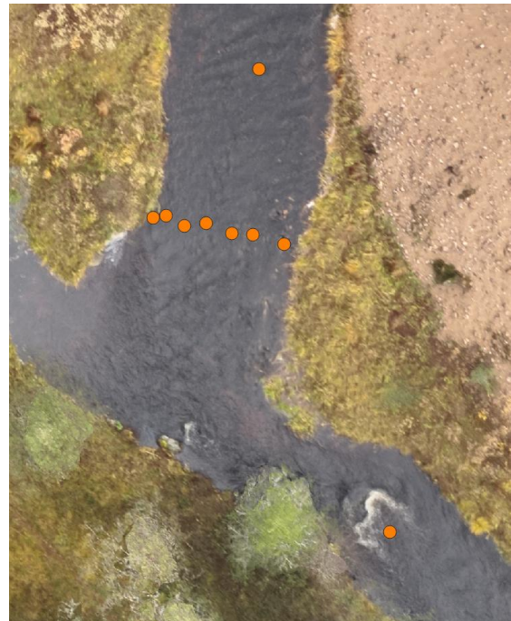
Kuva 5. Esimerkki GNSS-pisteistä joiden kohdalta joen pohjaa ei voimut erottaa ortokuvulta.
