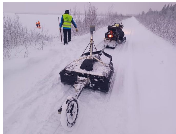
Kuva 3. Perinteinen maatutka moottorikelkan perässä olevassa ahkiassa, johon on liitetty myös RTK-GPS-vastaanotin.
