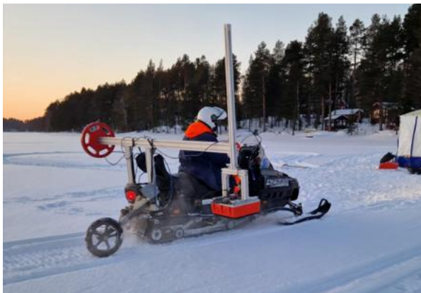
Kuva 4. Perinteinen maatutka moottorikelkkaan asennettuna ja korotettuna.
