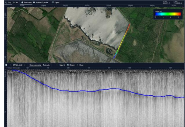
Kuva 16. Sama linja kuin maotkadroonilla Kuva 10 lennetty linja perinteisellä 200 MHz:n maotkalla vedettynä.
