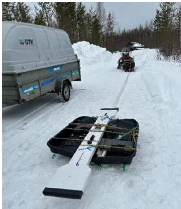
Kuva 7. GEM-2H-mittalaite liitettynä moottorikelkaan. Lähetin ja vastaanotin ovat kiinteästi 2.5 metrin päässä toisistaan laitteen vastakkaisissa päissä.
