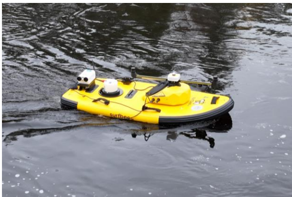
Kuva 4. Autonominen virtausmittauslautta Emäjoella syksyllä 2025.
