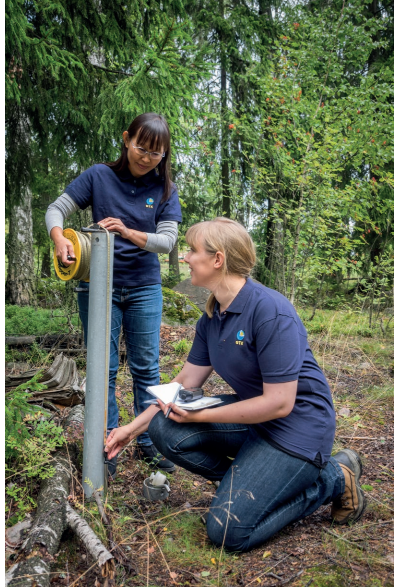
Geologit Samrit Luoma ja Tiina Nurminen valmistautuvat mittaamaan pohjaveden korkeutta Espoon Otaniemessä.
