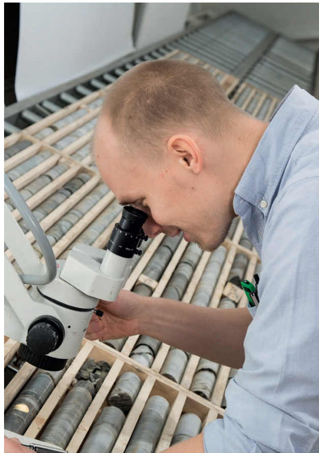
Geologi Janne Hokka tarkastelee kairasydämen mineralogiaa mikroskooppia apuna käyttäen.
