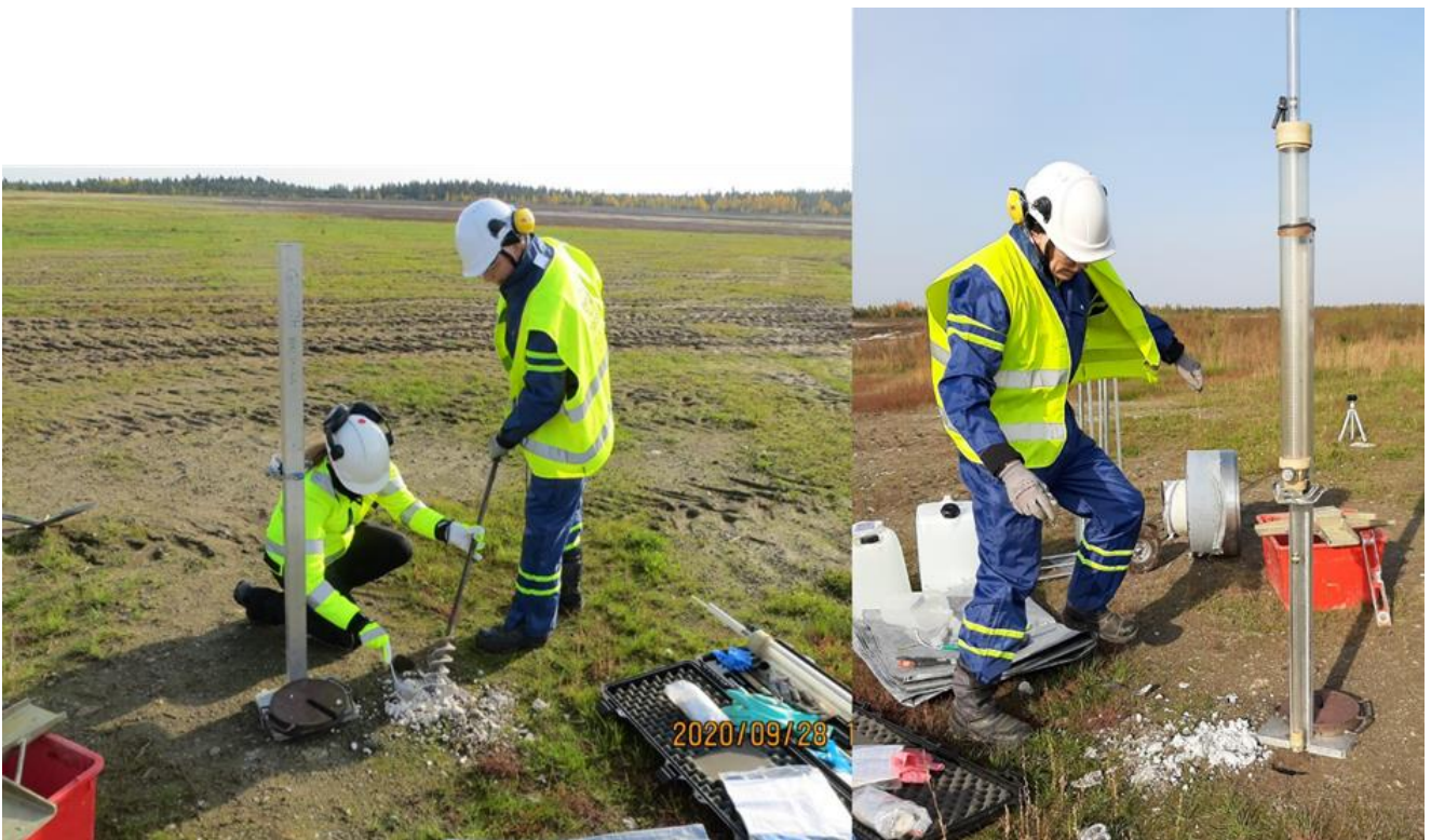
Kuva 29. In situ -mittauksissa käytetty Guelph-infiltrometrilaitteisto. Vasemmalla ollaan tekemässä kairausreikää mittausta varten. Oikealla näkyy hyvin mittalaitteisto ja sitä ollaan juuri asentamassa kairareikään, johon mittakärki lasketaan.
