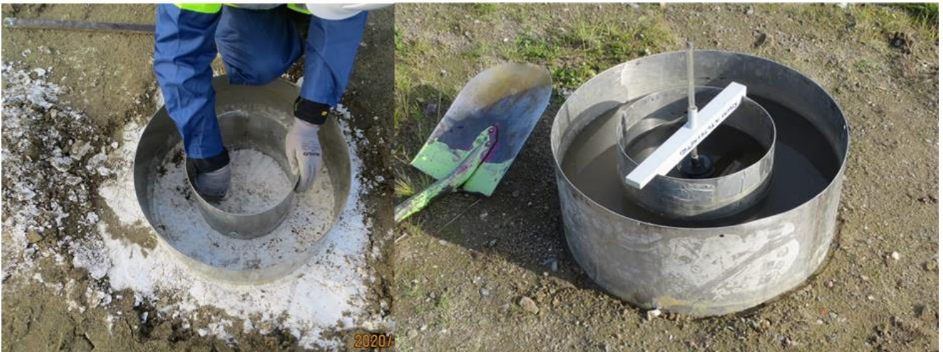
Kuva 28. In situ -mittauksissa käytetty rengasinfiltrometri. Kuvassa näkyy valkoisena pintarakenteesta käytetty opasakka.
