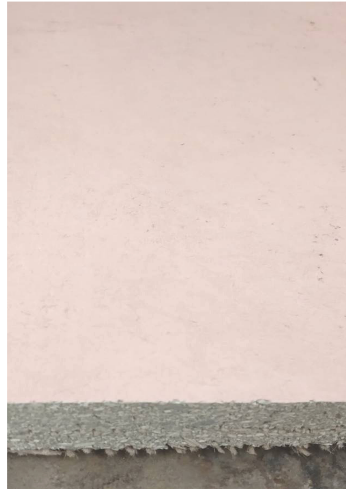
Savilevy kuivattiin ilmavirrassa ja levyn pinta maalattiin savesta ja tärkkelyksestä koostuvalla savimaalilla
