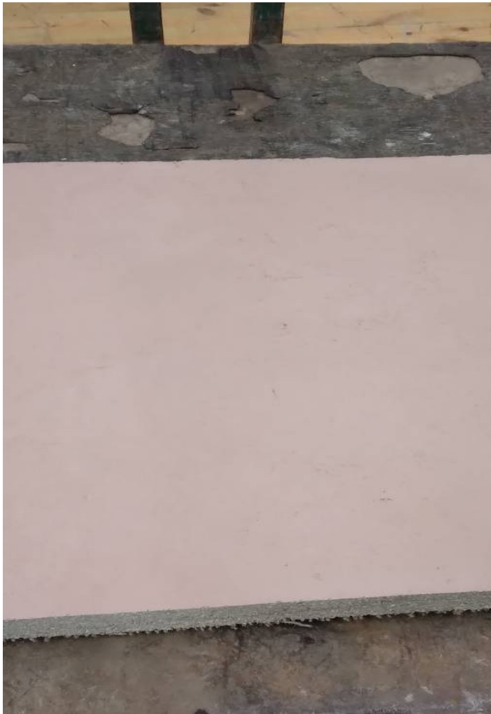
Savilevy kuivattiin ilmavirrassa ja levyn pinta maalattiin savesta ja tärkkelyksestä koostuvalla savimaalilla
